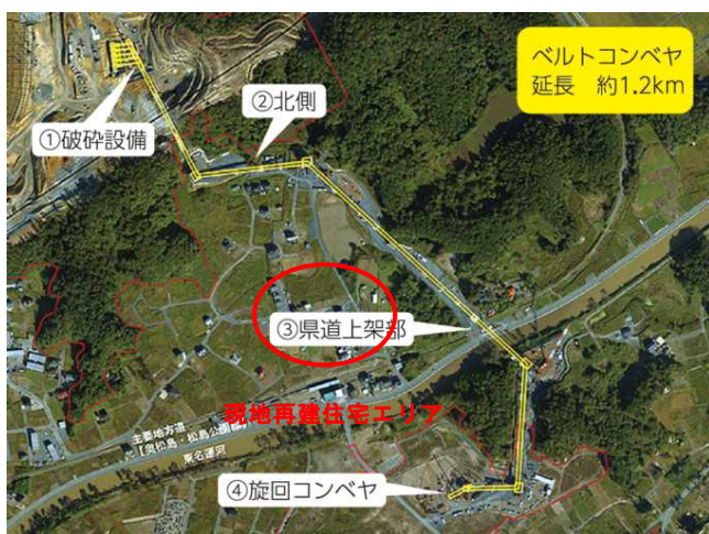
写真-1 ベルトコンベヤルート概要
