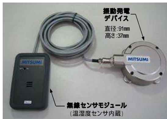
写真1 振動発電デバイスと無線センサモジュール
