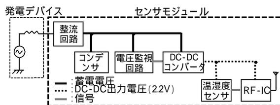
図6 センサモジュールのブロック図
