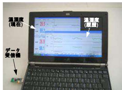
写真4 データ受信機およびモニタリングソフト画面
