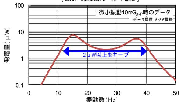
図4 振動発電デバイスの発電特性
