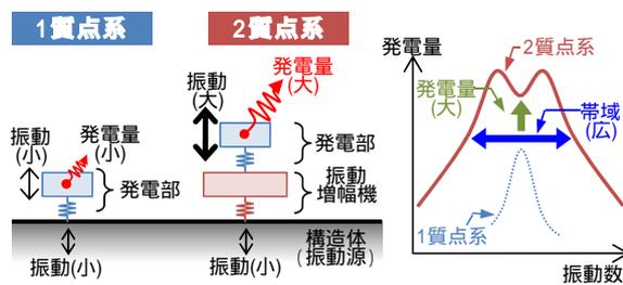
図3 2質点系の構成と効果(概念図)
