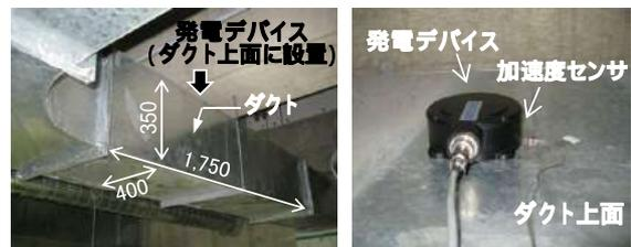
写真2 検証試験の実施状況
