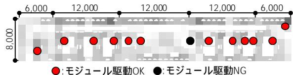
図7 実稼働オフィスの検証試験の結果
