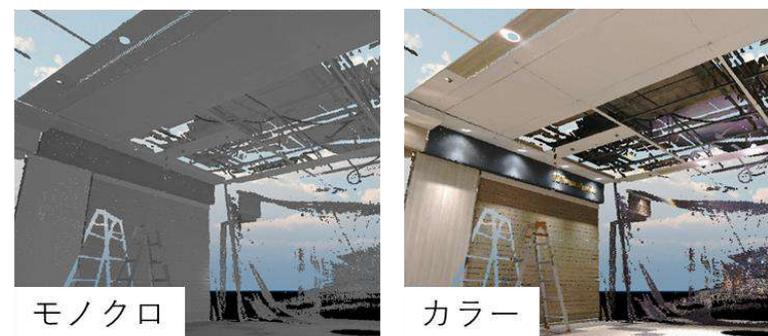
図4 天井部モノクロ、カラーデータによる画像の比較
