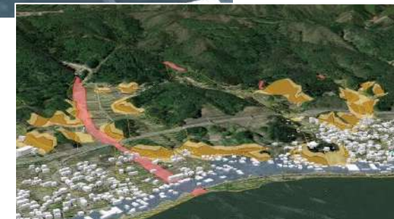
土砂法の急傾斜、土石流のレッドゾーン、イエローゾーンにかかる家屋を可視化
