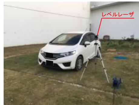
図-7 乗用車乗り入れ試験状況
