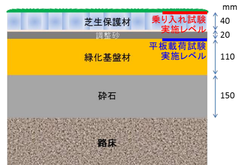
図-5 実証試験区の断面構成
