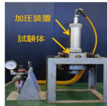
写真-5 防水性確認実験
