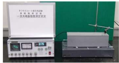
写真-8 相対動弾性係数の計測状況
