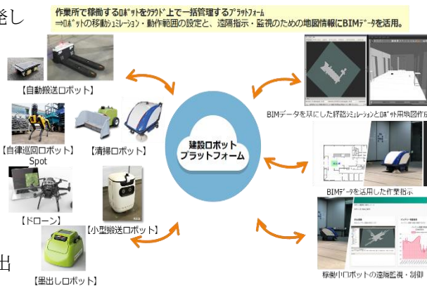
図5 建設ロボットプラットフォーム
