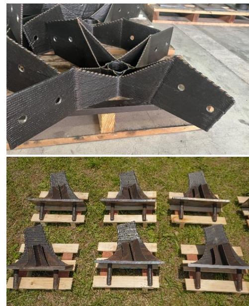
図 14 部材の製造状況 (上段:接合部モデル, 下段:基礎モデル)
